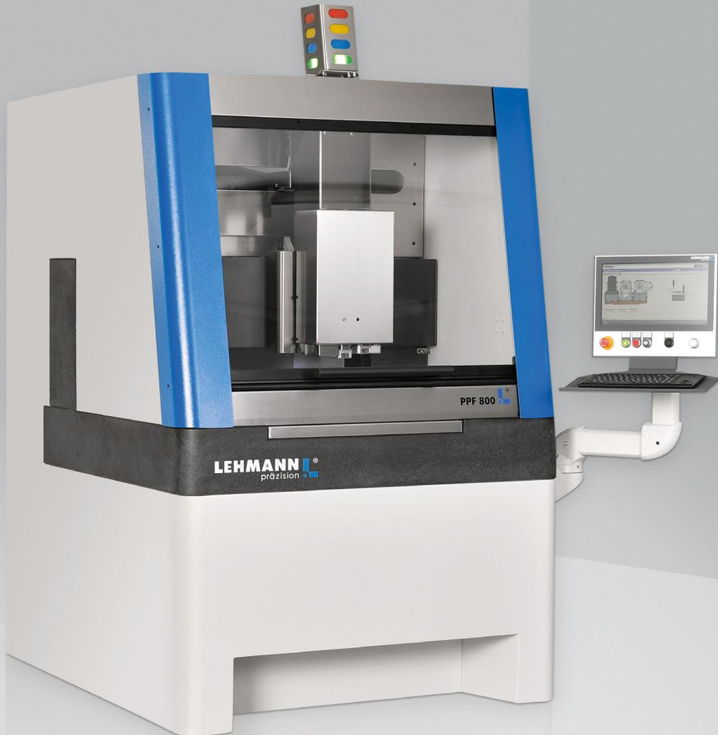
La fraiseuse à portique de précision a été développée principalement pour l'usinage de pièces plates. La conception compacte et rigide du portique la rend très précise et permet des valeurs d'accélération élevées et de hautes vitesses de déplacement des axes pour un usinage à la fois rapide et économique.
