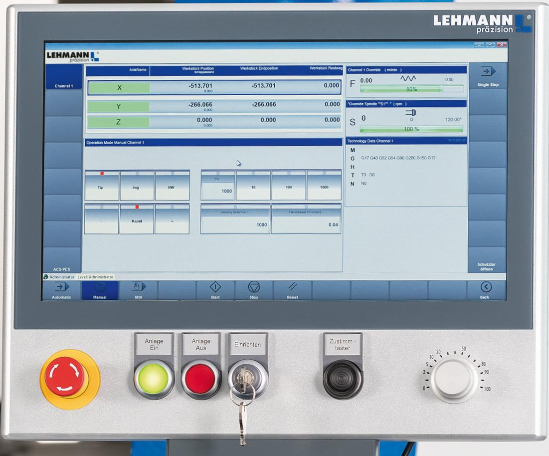
La machine est équipée d'un système de commande CNC moderne 2 ½ D avec écran tactile. Son système de menus est configuré de manière intuitive et structurée avec des écrans interactifs. Le programme peut être sécurisé à l'aide d'un mot de passe, de sorte que chaque opérateur de la machine peut y avoir accès par le biais d'un code électronique individuellement configuré.
