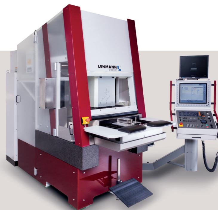
Ultrapräzisions-Fräsmaschine in Pendeltisch-Ausführung.
